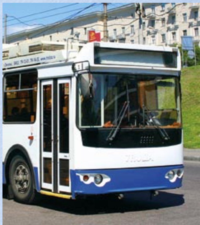
Со сдвоенной передней дверью (вариант под установку автоматизированной системы контроля пассажиров) With two-wing front door (the variant is good for automatic passenger control device installation)
