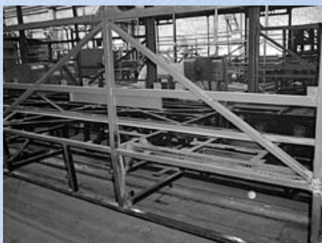
Основание и каркас кузова троллейбуса ЗиУ-682Г-016.02 Base and frame of ZiU-682G-016.02 model
