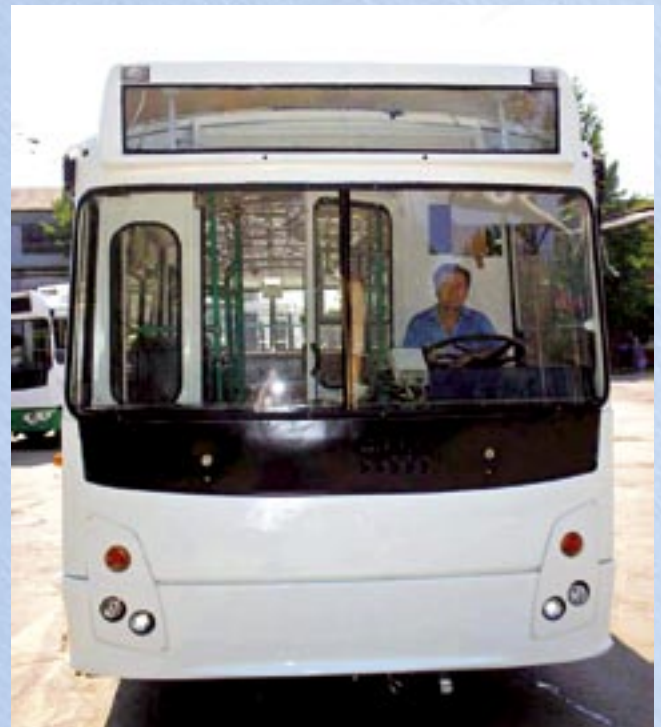
Вариант исполнения с галогенными светотехническими приборами Variant with using haloid lamps
